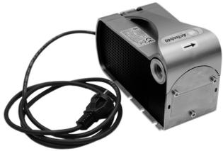
40 lt/min. Pour le transfert du diesel. Avec tuyau de sortie, tuyau d'aspiration et pistolet de distribution en plastique. Electropompe rotative auto-amorçante volumétrique à palettes, avec soupape By-pass et filtre 100 µ. Moteur asynchrone monophasé, à d
